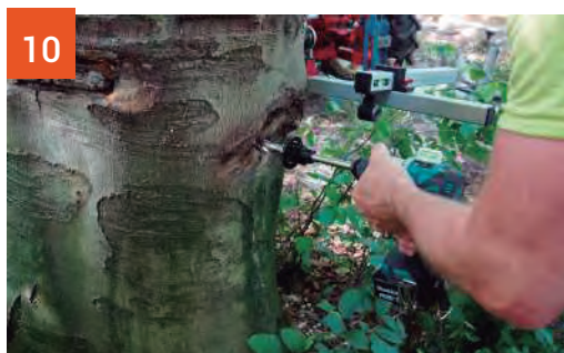
Colocar la plantilla de montaje
