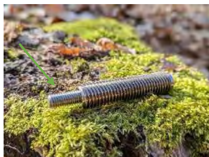
2.6.5 En maderas blandas se recomienda como opción la instalación de un adaptador RAMPA tipo SKL, en acero inoxidable 1.4305, D 18,5, d M10, L 80 mm. ETA-12/048 1.
