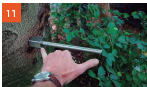
Atornillar la varilla roscada con el proyector de acero inoxidable
