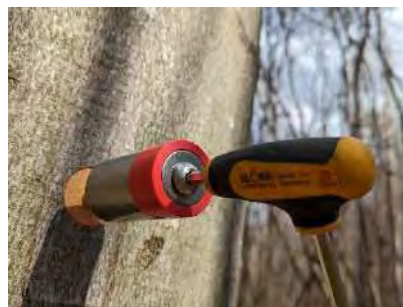
2.6.2 Preparar un agujero de 4 cm de profundidad con una broca de 4 mm.
