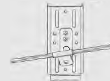
Geeignete Verankerung an Bäumen
