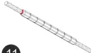
11 Vérification du déplacement des câbles aux jonctions avec les connecteurs de câble
