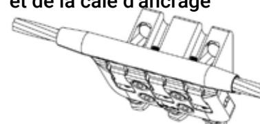
Assemblage de l'ancrage et du bras articulé
