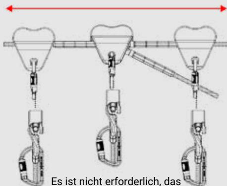
Es ist nicht erforderlich, das MSS zu manipulieren, wenn das Produkt in einem Winkel von 35° zur vertikalen Achse installiert wurde
