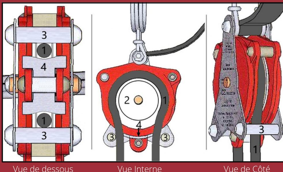
Étape 3 : Vérifier que la corde (1) est correctement installée dans l'appareil, en la tirant doucement dans les deux sens. Elle doit circuler librement et sans entrave.
