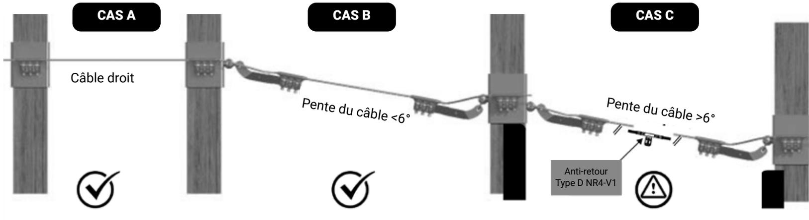
Lorsque le câble est relativement droit, il est recommandé d'utiliser un ancrage ou une cale d'ancrage, vissé sur le poteau directement ou indirectement
