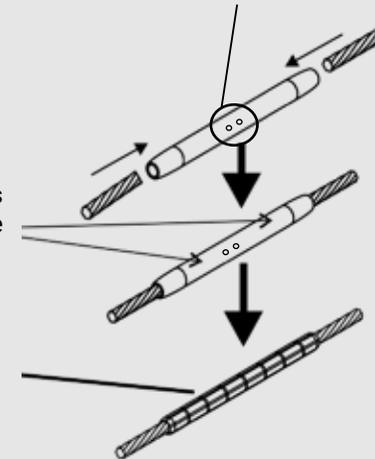
4 sertissages doivent être effectués sur chaque connexion de câble
