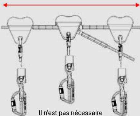
Il n'est pas nécessaire de manipuler le DCM si le produit a été installé à 35° par rapport à l'axe vertical
