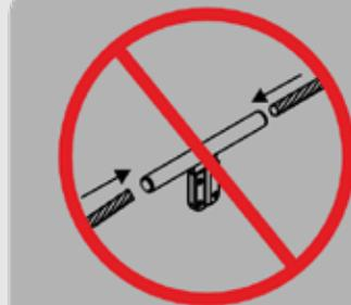
Il est interdit d'installer ce composant en tant que connecteur de câble
