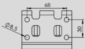
Dimensions des trous de la cale d'ancrage
