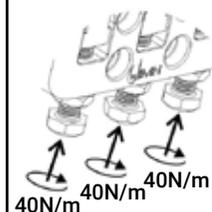
Pour fixer le câble de sécurité, vous devez exercer un couple de 40N/m sur chaque vis M10. Une clé dynamométrique doit être utilisée pour ne pas dépasser cette valeur
