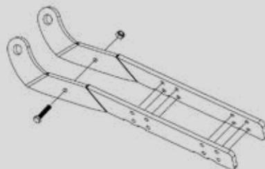
DIN 933 Vis M8x35 (min.) A2 **x1**
