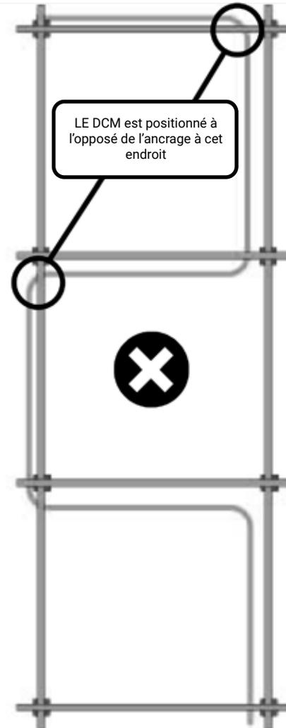
Attention. Si la trajectoire est interne, un contrôle approprié doit être effectué en positionnant des ancrages sur des bras articulés
