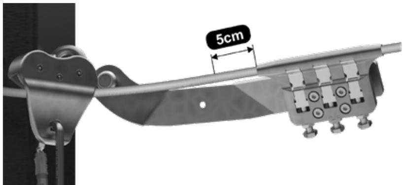
La courbe décrite par le câble doit avoir une longueur de 40-45 cm, mesurée de la sortie de l'ancrage à l'entrée de l'ancrage suivant
