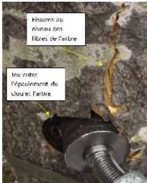
(Note: photo exemple ci-dessus réalisée lors d'essai en arrachement sur le clou)
