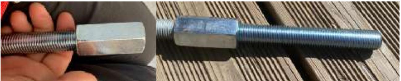
**NOTE 1 :** le numéro de lot du clou ne sera plus visible une fois le manchon de raccordement installé, et il convient donc de REPORTER ce numéro de lot sur le manchon de raccordement.
