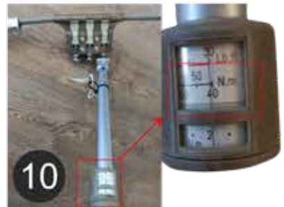
Vérification du serrage des vis M10 dans les ancrages LDV (=40N*m)
