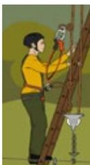
Das C-CONNECT V2-Element kann zwischen dem Verbindungselement eines Höhensicherungssystems (wie Maillon Rapide oder lösbarem Verbinder) und CLiC-iT-Verbindern verwendet werden.
