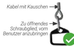
Das C-CONNECT 25 Element kann zwischen dem Verbindungselement eines Höhensicherungssystems (wie Maillon Rapide oder lösbarem Verbinden) und CLiC-iT-Verbindern verwendet werden.
