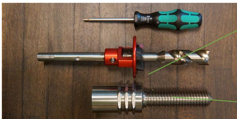
**IMPORTANT** : Avant de serrer les deux vis Allen, alignez la surface de la tige du perceur (hexagone) perpendiculairement aux deux vis Allen.
