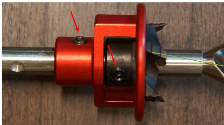
La position de la fraise et de la butée de profondeur peut être ajustée à la longueur de la vis en desserrant les **deux vis sans tête**.
