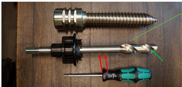
Sélectionnez le diamètre de perçage correspondant à la vis.
